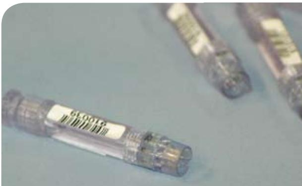
Die Substratträger, die im Fraunhofer IBMT die Bioproben enthalten, sind mit Barcode und Beschriftung sowie mit RFID- und Datenchips versehen. Damit ist die redundante Identifizierung und Datenhaltung zu jeder Probe möglich. Die Substrate können im Tiefkühlschrank elektronisch angesteuert werden.
