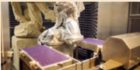
Roboter zur Probenein- und Ausgabe. Sie stammen ursprünglich aus der Autofertigungsindustrie und wurden für den Tieftemperaturbereich umgerüstet.
